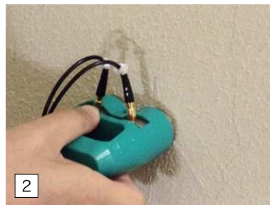
2 探触子に接触媒質を塗布し、近傍健全部に探触子を押し当てる
