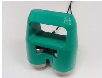
左：ひび割れ深さ評価装置(ひび割れチェッカー)
