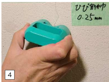
4 探触子に接触媒質を塗布し、ひび割れを挟んで探触子を押し当てる
