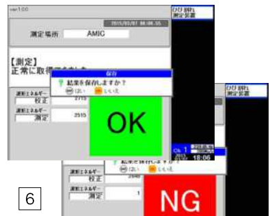
6 モルタル内でひび割れが止まっていれば『OK』、ひび割れが躯体内部まで達していれば『NG』を表示
