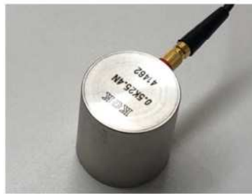
左：モルタル厚さ測定装置(UI-27LF) 右：探触子
