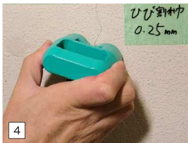
4 探触子に接触媒質を塗布し、ひび割れを挟んで探触子を押し当てる
