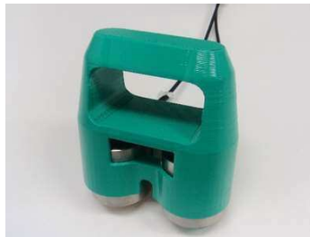
左：ひび割れ深さ評価装置(ひび割れチェッカー) 右：探触子 (平成25・26年度 国交省住宅局補助事業にて開発)
