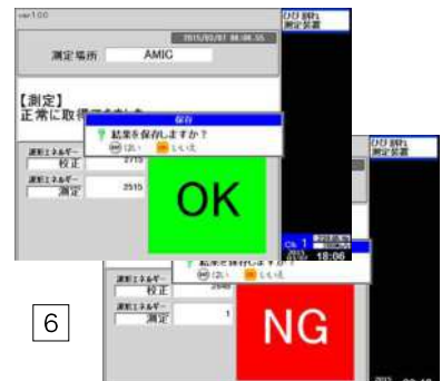
6 モルタル内でひび割れが止まっていれば『OK』、ひび割れが躯体内部まで達していれば『NG』を表示
